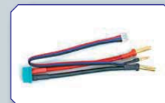
Adapterkabel G4/MG6 Best. Nr. 3041.MG6 Adapterkabel mit akkuseitigen G4 Hochstromsteckern und 2 mm Balan- cerstecker für Regler mit den entspre- chenden Anschlüssen. Durch den Bal- anceranschluss auch geeignet zum Laden.
