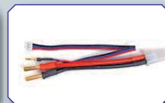
Adapterkabel G4/G2 Best. Nr. 3041.G2 Adapterkabel mit akkuseitigen G4 Hochstromsteckern und 2 mm Balan- cerstecker für Regler mit den entspre- chenden Anschlüssen. Durch den Bal- anceranschluss auch geeignet zum Laden.
