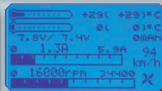
Brushless Control+T Anzeige Drehzahl, Stromaufnahme aktuell+ (Spitzenwert) Temperatur, Stromverbrauch
