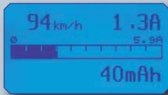
Brushless Control+T Anzeige Geschwindigkeit, Stromaufnahme, Stromverbrauch
