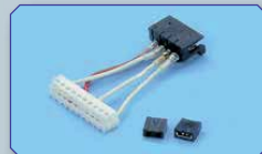
NAUTIC-Adapter mc-22/mc-24 Best. Nr. 4184.4 Zum Anschluss der NAUTIC-Multi-Prop-Module, Best.-Nr. 4141 oder NAUTIC-Expert-Module, Best.-Nr. 4108, an den Sendern mc-22 und mc-24. Die beiliegenden Kurzschlussbrücken müssen auf die senderseitigen NAUTIC-Module aufgesteckt werden.
