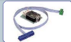
Lehrer/Schüler-KabelHands-/ Handsender Best. Nr. 4179.1 mit DSC-Buchse mx-12, X-347, X-388 S, X-3810 Best.-Nr. 4179.1. Mit dem Kabel ist es möglich, mit GRAUPNER Handsendern einen Lehrer-Schüler-Betrieb durchzuführen. Eine Kombination mit GRAUPNER mc-Sendern ist mit diesem Lehrer-/Schüler-Kabel nicht möglich.
