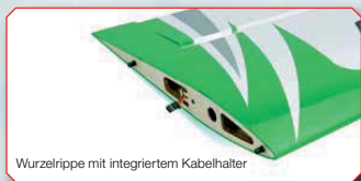
Wurzelsippe mit integriertem Kabelhalter
