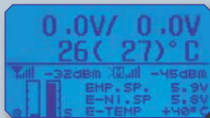
Empfänger Anzeige Spannung und Temperatur ext. Sensor Empfängerspannung, Empfangsstärke und Qualität, Empfängertemperatur
