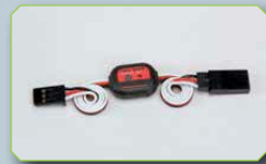
Fail Safe Micro Modul 4,8-6V Best. Nr. 98023 Ideales Modul für das Gas/Brems-Servo. Bei Störungen kann eine gewünschte Servostellung vorprogrammiert werden, z.B. Bremse oder Neutralstellung, um Beschädigungen vom Modell oder gar Personenschäden vorzubeugen.
