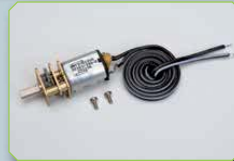
Micro Getriebemotor Best. Nr. 1753 Geeignet für Sonderfunktionen in Schiffsmodellen, wie z.B. beim Tonnenleger RANZOW zum Antrieb des Arbeitskranes. Freie Wellenlänge 7 mm Gehäuselänge 24 mm Gewicht ca. 12 g Leerlaufdrehzahl 45 U/min Leerstromaufnahme ca. 80 mA Nennspannung 5 V Stromaufnahme bei max. Leistung @ 7,2 V 0,8 A Übersetzung 2,98:1 Wellen-Ø 3 mm
