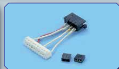
V-Mixer Best. Nr. 3020 Kreuz-Mix-Modul für Delta-, Nurfügel- und V-Leitwerksmodelle. Das V-Mix-Modul ermöglicht ein empfängerseitiges gleich- und gegensinniges Koppeln zweier Servofunktionen, wie z.B. Höhen-/Seitendrusservos bei V-Leitwerksmodellen oder Höhen-/Querruderservos bei Delta- oder Nurfügel Flugmodellen. Das Modul kann auch zur Koppelung von zwei Querrudern benutzt werden, die durch eine weitere Funktion als Flaperon gemeinsam verstellbar sind z.B. Landebremse.
