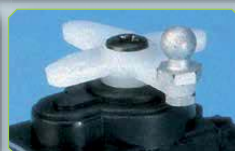
Kugelgelenk 6x14 mm (10 Stk.) Best. Nr. 3675.14 Kugelgelenk-Gestängeanschluss Anschraubbar an den Ruderarm von Drehservos. Befestigungsgewinde M3 x 5 mm, Kugel-Ø 5,8 mm, passend zu Kugelpflanze Best.-Nr. 4857.30. 10er-Packung.
