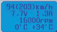
Brushless Control+T Anzeige Geschwindigkeit, Drehzahl, Stromaufnahme, Temperatur, Stromverbrauch
