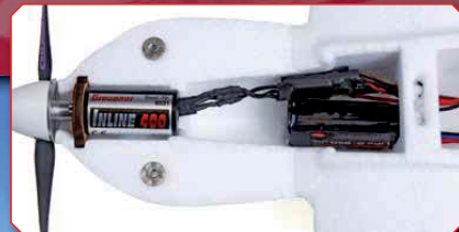
Optimaler Zugang zur Antriebseinheit bei abgenommener Rumpfabdeckung Motor, Drehzahlregler und LiPo-Akku nicht enthalten
