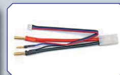
Adapterkabel G4/JST Best. Nr. 3041.JST Adapterkabel mit akkuseitigen G4 Hochstromsteckern und 2 mm Balan- cerstecker für Regler mit den entspre- chenden Anschlüssen. Durch den Bal- anceranschluss auch geeignet zum Laden.
