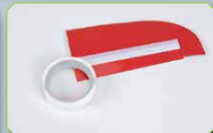
Spalt-Abdeckband weiß, 5 m Best. Nr. 90 Selbstklebendes Band zum Überbrü- cken des Spaltes zwischen Ruder und Flosse bei Tragflächen und Höhenleit- werken etc. Die Flugleistungen des Mo- dells werden dadurch wesentlich ver- bessert. Das Band ist vorgebogen damit es auch noch bei einem Aus- schlag nach oben am Ruder anliegt. Abmessungen 22 mm breit, 0,2 mm dick, 5 Meter lang.
