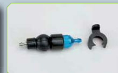
Kraftstofffilter m.Pumpe Oneway Best. Nr. 98019 Zum Ansaugen/Pumpen des Kraftstoffs in den Vergaser, pumpt nur in eine Richtung. Einbaurichtung muss beach- tet werden.
