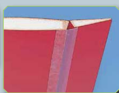
Spalt-Abdeckband Best. Nr. 63 Spalt-Abdeckband Dieses selbstklebende 21 mm breite Band wird verwendet, um den zwi- schen Ruder und Flosse bei Tragfläche, Höhenleitwerk etc. entstehenden Spalt abzudecken. Dadurch wird die Leistung des Modells wesentlich verbessert. Da- mit das Abdeckband auch noch bei ei- nem Ausschlag nach oben anliegt, ist es sozusagen vorgebogen. Abmessun- gen 21 mm breit, 0,2 mm dick. Pa- ckung mit 5 Meter.
