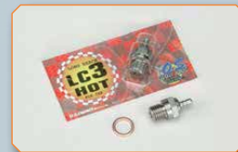
Glühkerze O.S. Typ LC-3 hot Best. Nr. 1571 Speziell für RC-Car-Modelle konzipierte, langlebige „heiße" Glühkerze für hoch nitrierte Kraftstoffe. Weniger Kraftstoffverbrauch durch niedrigere Motortemperatur.
