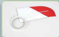
Zackenband weiß, 5 m. Best. Nr. 91 Das Zackenband wird zur Verbesse- rung des Flugverhaltens eines Flugmo- dells angewendet. Hierdurch wird eine turbulente Strömung erzeugt. Ein Strö- mungsabriss erfolgt gegenüber lamina- rer Strömung gar nicht oder erheblich später. Breite ca.9 mm, Dicke ca. 0,4 mm, Spitzenabstand ca. 6 mm, Zackenwin- kel 60°
